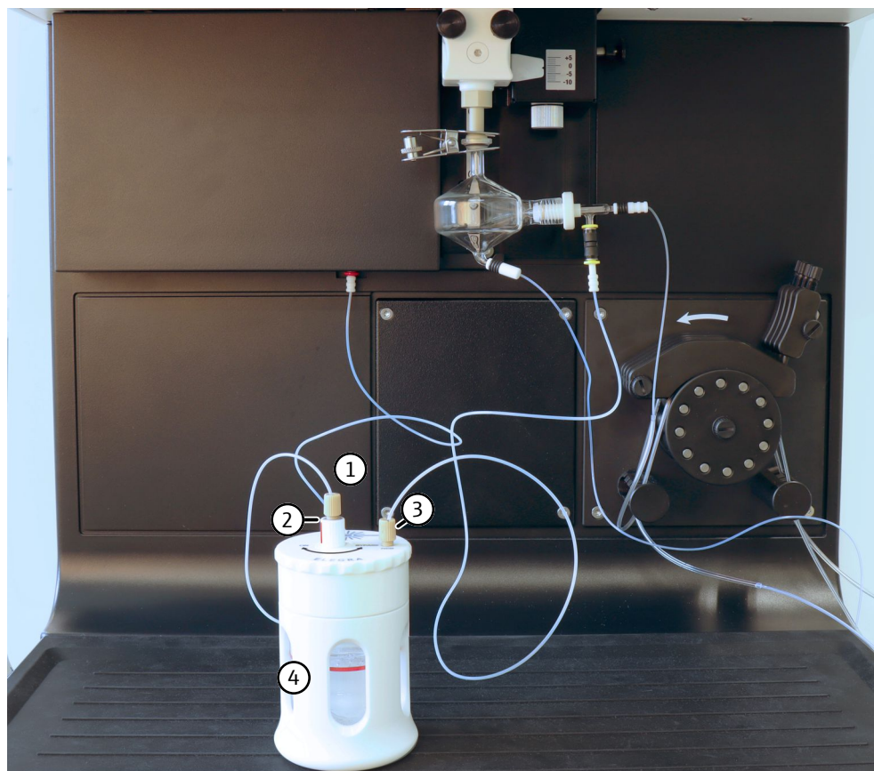
图 33 安装氙气加湿器
