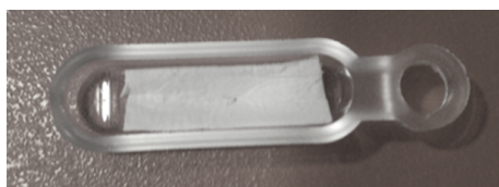
Fig. 24 Nacelle en quartz avec de la laine de quartz placée correctement
