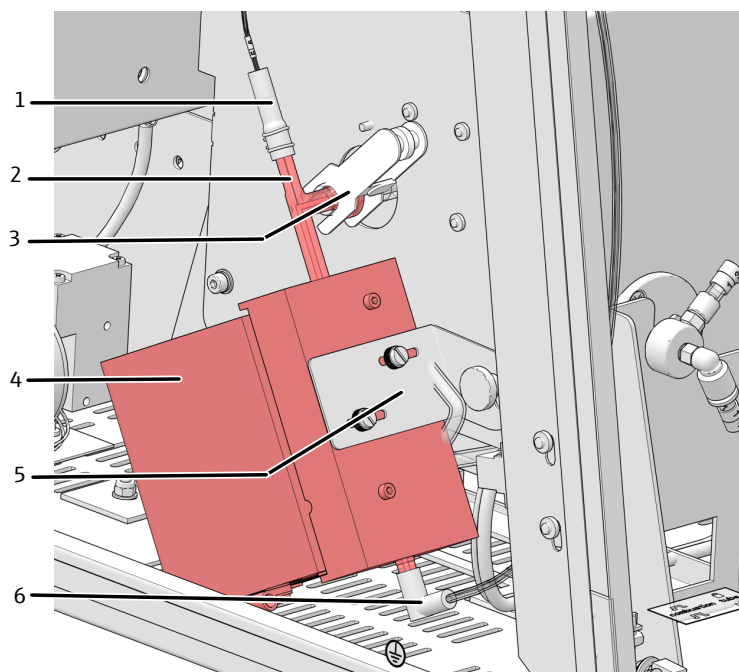
Fig. 12 Bloque de refrigeración Peltier con conector en T
