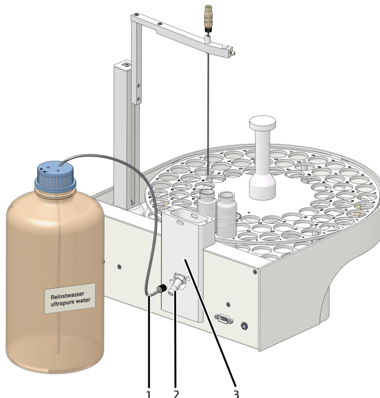
Fig. 22 Enjuague de cánulas en el colector de fracciones
