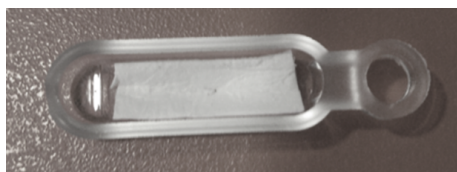
Fig. 24 Navecilla de cuarzo con vellón de cuarzo correctamente insertado
