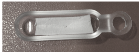
Abb. 24 Quarzschiffchen mit korrekt eingelegtem Quarzvlies
