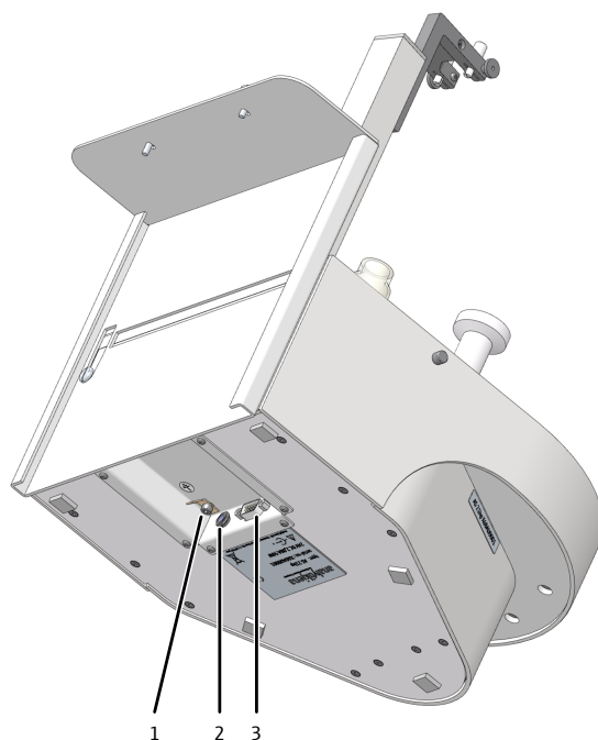
Изобр. 21 Разъемы на нижней стороне автосамплера
